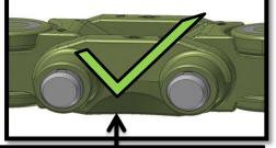
**RELIEF BEVEL MUST BE DOWN AS SHOWN**
